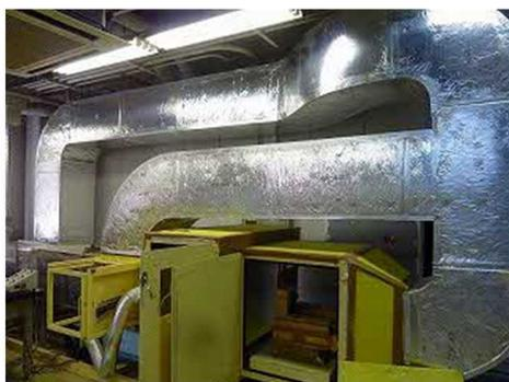
写真3-4 温度ヒューズ試験装置
