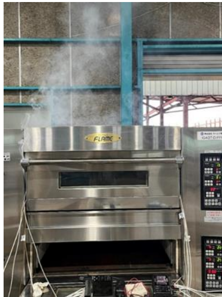
写真7 庫内温度 400°C 時の密閉式デッキオーブン
