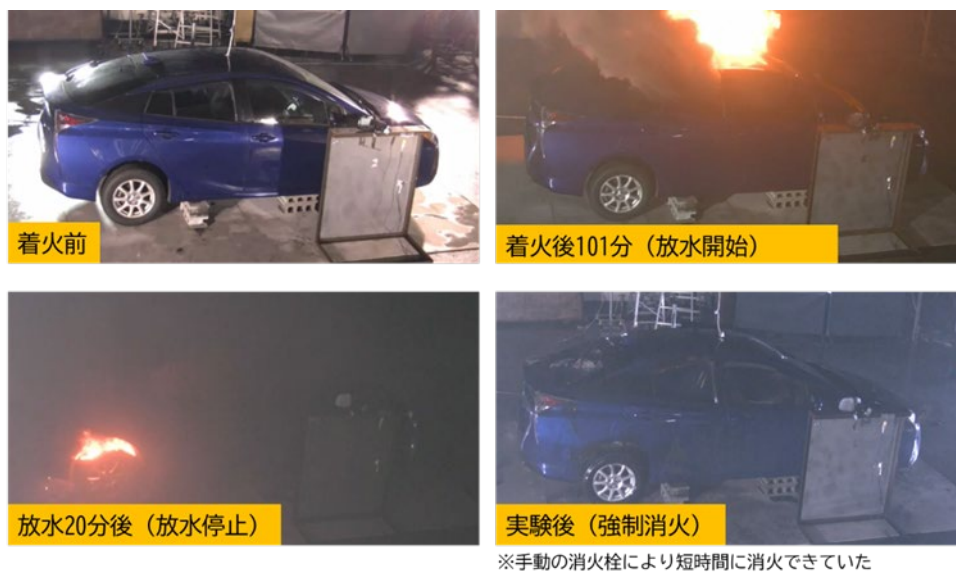
図 5.1.6 実験実施状況 (閉鎖型水噴霧設備)
