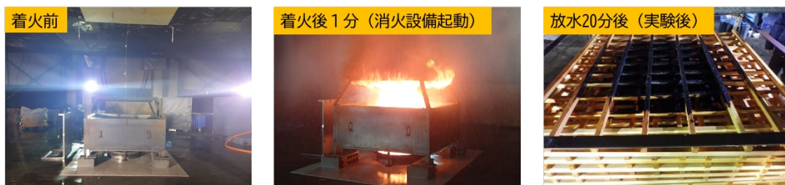
図 5.2.4 実験実施状況（閉鎖型水噴霧設備）
