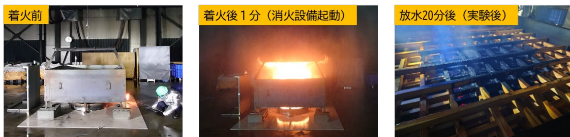
図 5.2.1 実験実施状況 (スプリンクラー設備)
