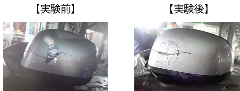
図 5.1.7 実験後の隣接車両位置のミラーの状況 (閉鎖型水噴霧設備)
