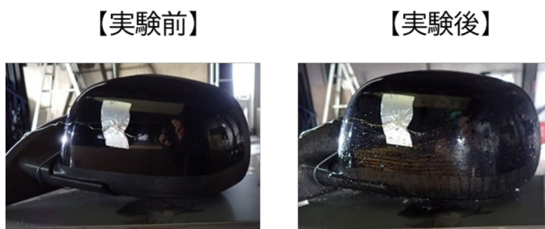
図 5.2.5 実験後の隣接車両位置のミラーの状況（閉鎖型水噴霧設備）
