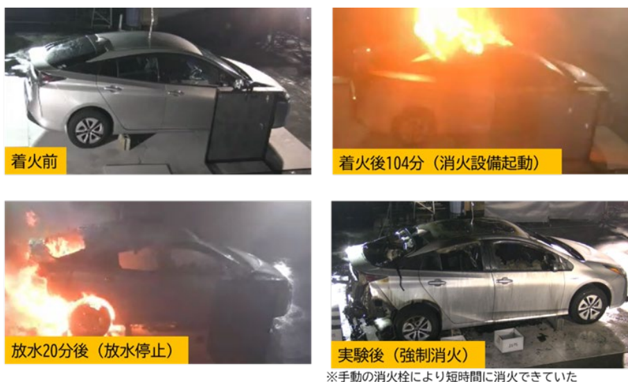
図 5.1.1 実験実施状況（スプリンクラー設備）
