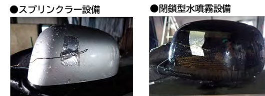
実験後の隣接車両のドアミラーの状況
