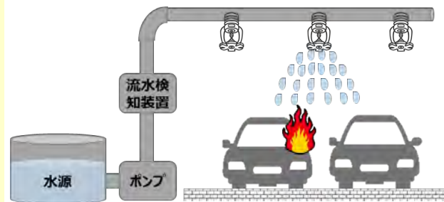
スプリンクラー設備の作動イメージ
