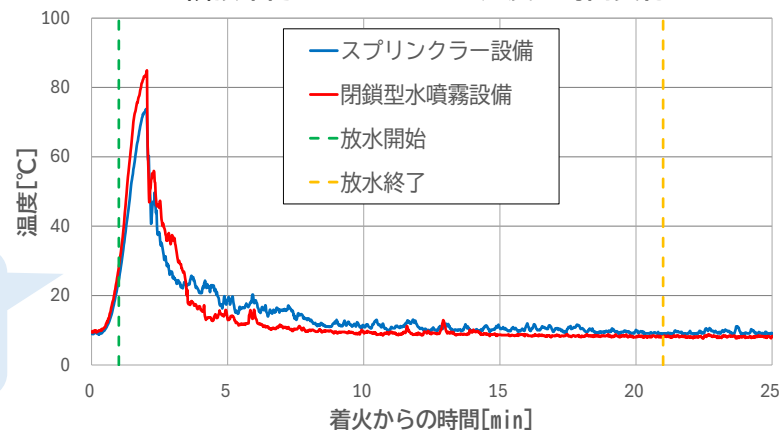
隣接車両のドアミラーの温度の時間変化
