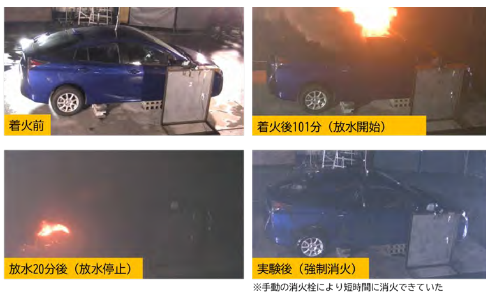
図 5.1.6 実験実施状況（閉鎖型水噴霧設備）
