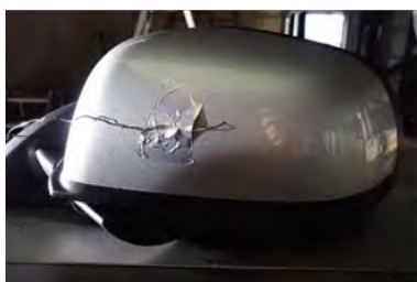
図 5.2.2 実験後の隣接車両位置のミラーの状況（スプリンクラー設備）
