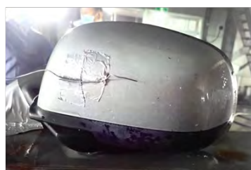
図 5.1.7 実験後の隣接車両位置のミラーの状況（閉鎖型水噴霧設備）
