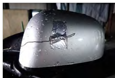
図 5.2.2 実験後の隣接車両位置のミラーの状況（スプリンクラー設備）
