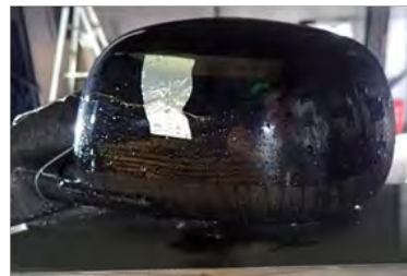
図 5.2.5 実験後の隣接車両位置のミラーの状況（閉鎖型水噴霧設備）
