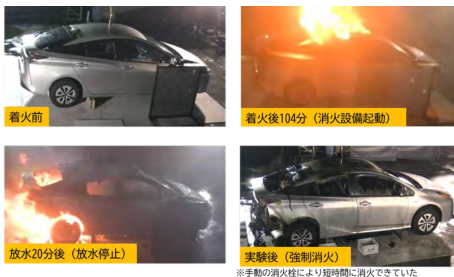
図 5.1.1 実験実施状況（スプリンクラー設備）
