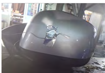
図 5.1.7 実験後の隣接車両位置のミラーの状況（閉鎖型水噴霧設備）
