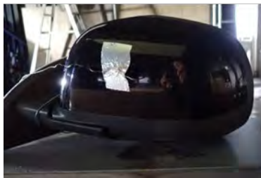
図 5.2.5 実験後の隣接車両位置のミラーの状況（閉鎖型水噴霧設備）
