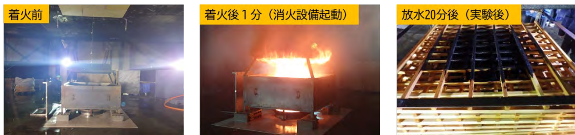
図 5.2.4 実験実施状況（閉鎖型水噴霧設備）
