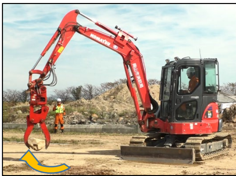
【瓦礫持ち上げ旋回例】
