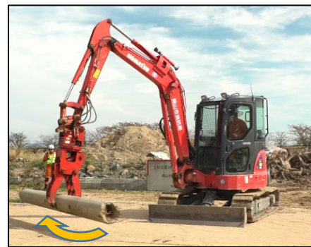
【電柱持ち上げ旋回例】
