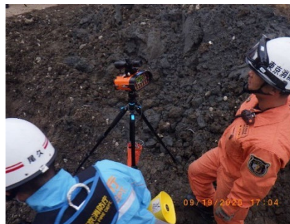
【土砂災害遠隔監視装置設定状況】
