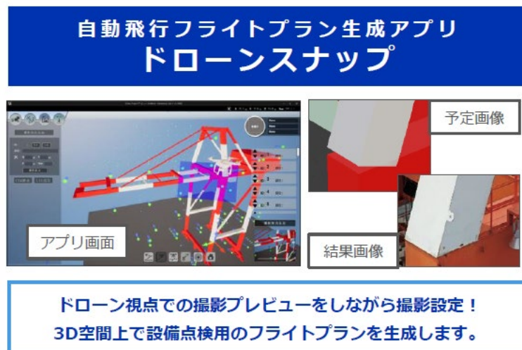
図 5-1 3D マップ上での自動飛行ルート及び撮影指示 アプリ
