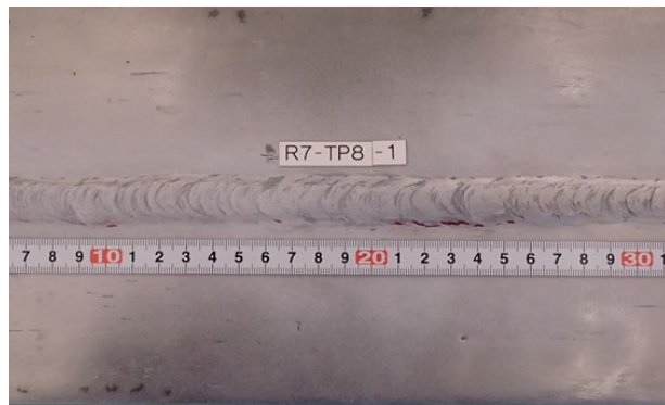
図 2-10 試験片外観（TP-8：きれいな突合せ継手 割れ）
