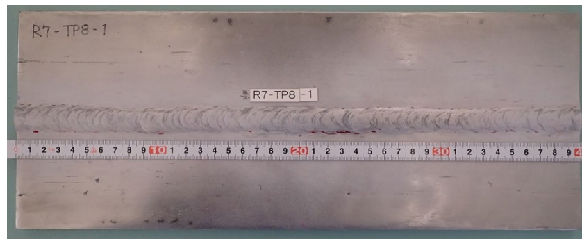
図 溶接自然割れ試験片 (R7-TP8、突合せ継手、綺麗な手動)
