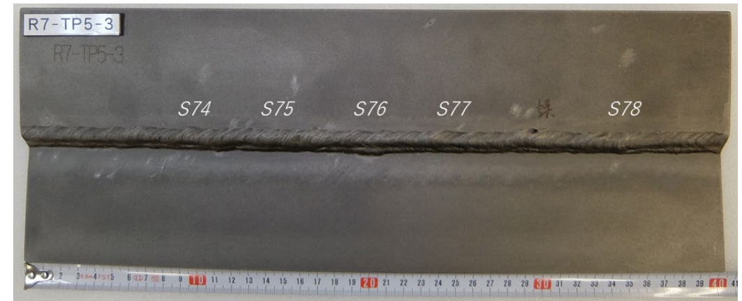
図 溶接試験片 (R7-TP5、重ね継手、綺麗な手動)
