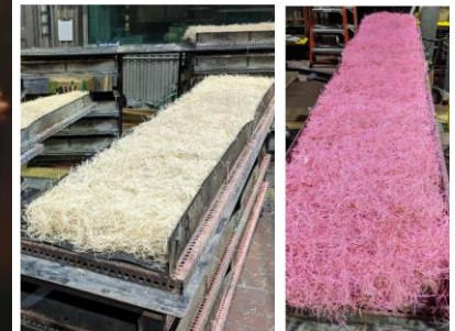
燃焼ベット (縦2.4m、横0.5m) 散布後
