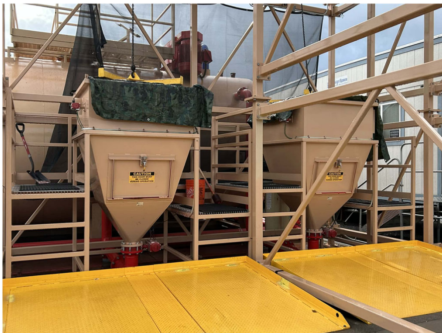
リターダントの製造設備 （粉末と水の混合）
