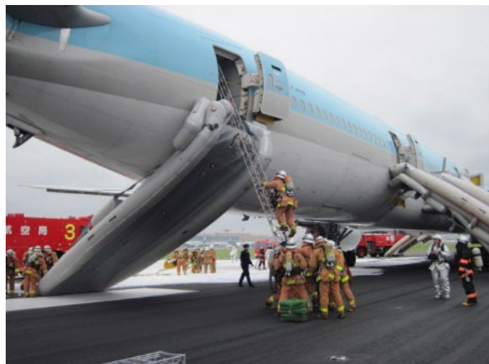
図 7.16. 三連はしごによる機内進入例
