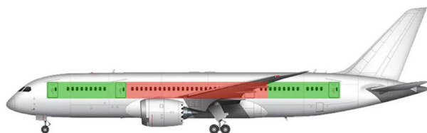
図 7.30. B787(CFRP 製)機体切断場所
