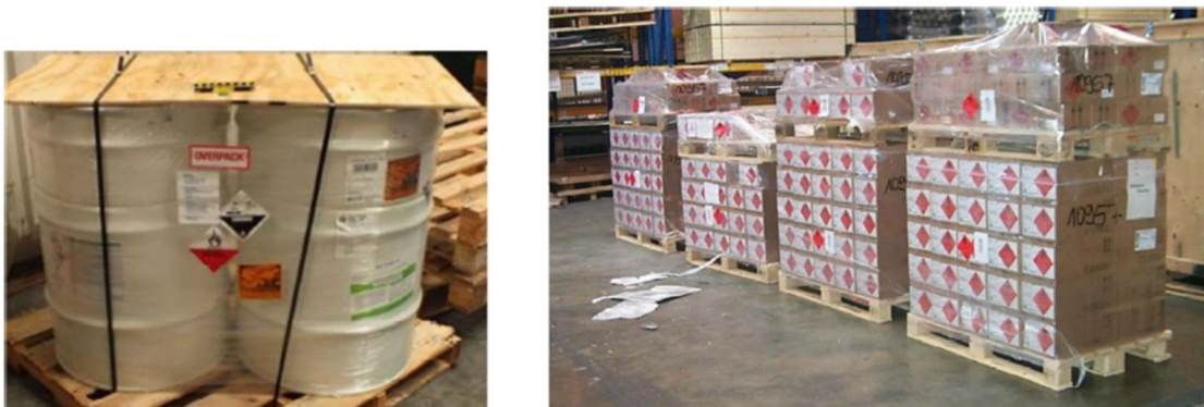
図 7.18. オーバーパック(混合包装)における表示
