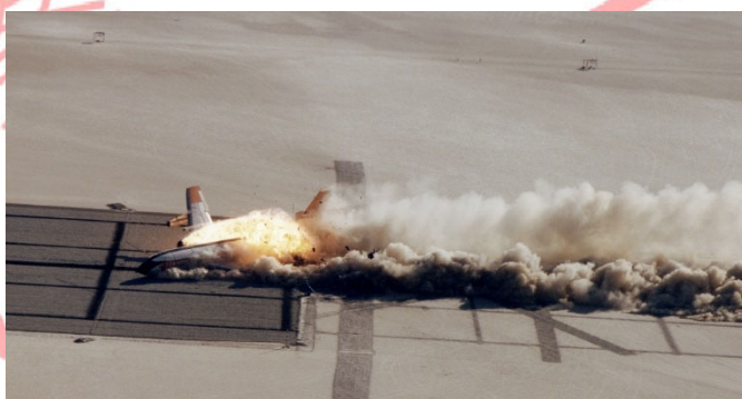
図 7.21. NASA の制御衝撃実演(CID)の様子
