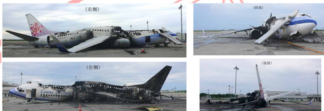
図 7.1. 金属製機体の損傷状況
