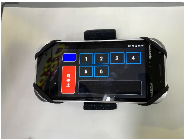
可搬式制御装置（給油許可「可」）
