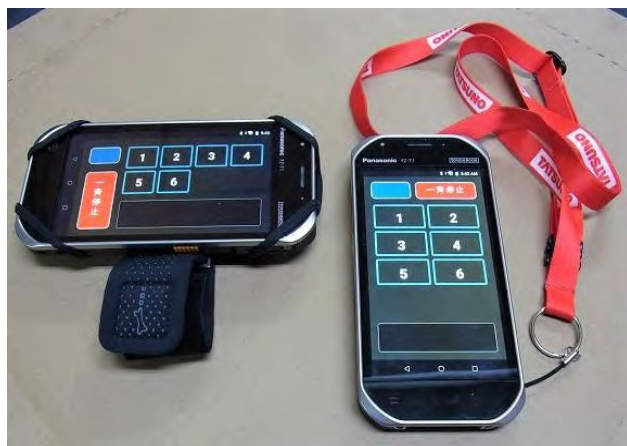
図2 可搬式の制御装置
