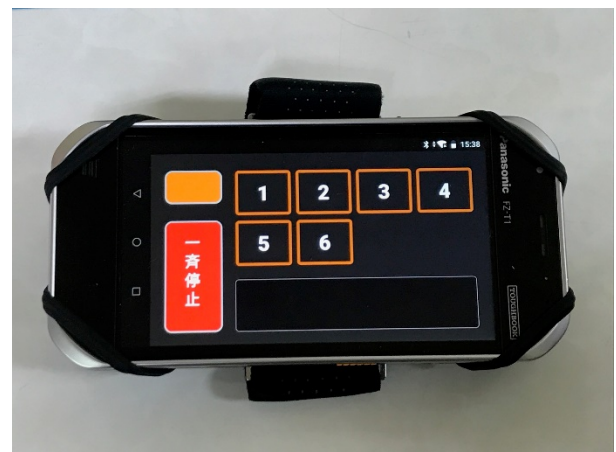
可搬式制御装置（給油許可「不可」）
