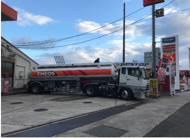
図 16 移動タンク貯蔵所による荷卸し作業 (中古車は一時的に移動)
