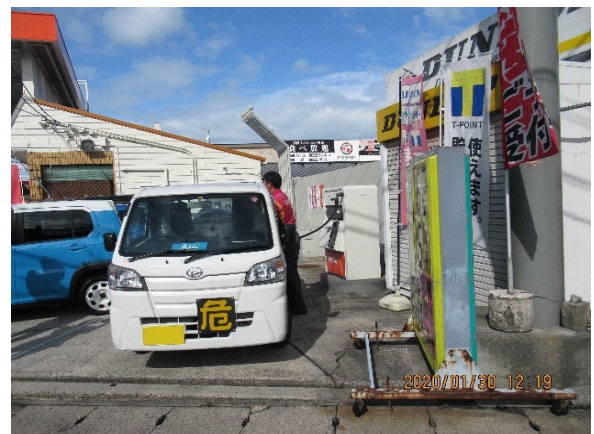
図 15 固定注油設備における取扱い作業 （ミニローリーへの荷積み）
