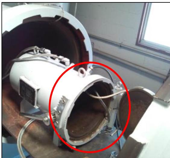
防爆チャンバー：およそ横 60cm×高さ 30cm の円筒形
