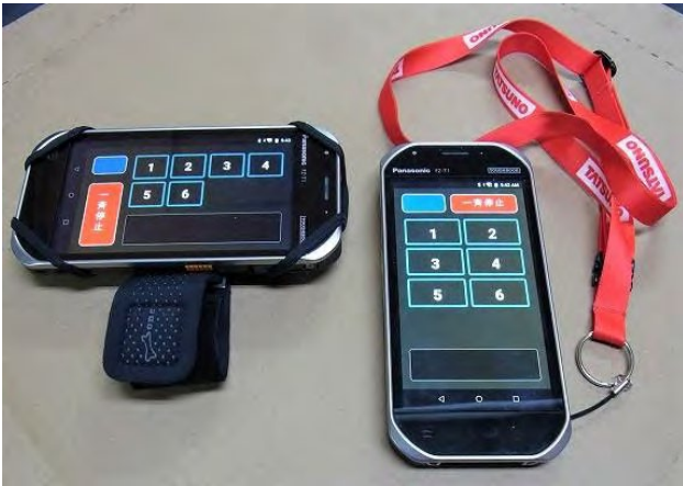
図2 可搬式の制御装置
