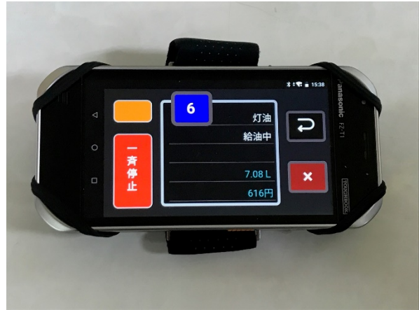
図3 可搬式の制御装置(給油中)
