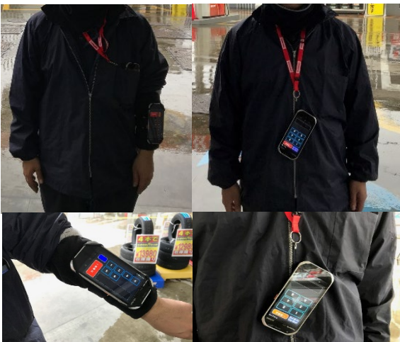
図4 可搬式の制御装置装着イメージ (左:腕バンド、右:首掛けストラップ)
