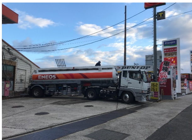
図 19 移動タンク貯蔵所による荷卸し作業 （中古車は一時的に移動）
