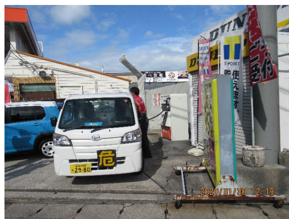
図 18 固定注油設備における取扱い作業 （ミニローリーへの荷積み）
