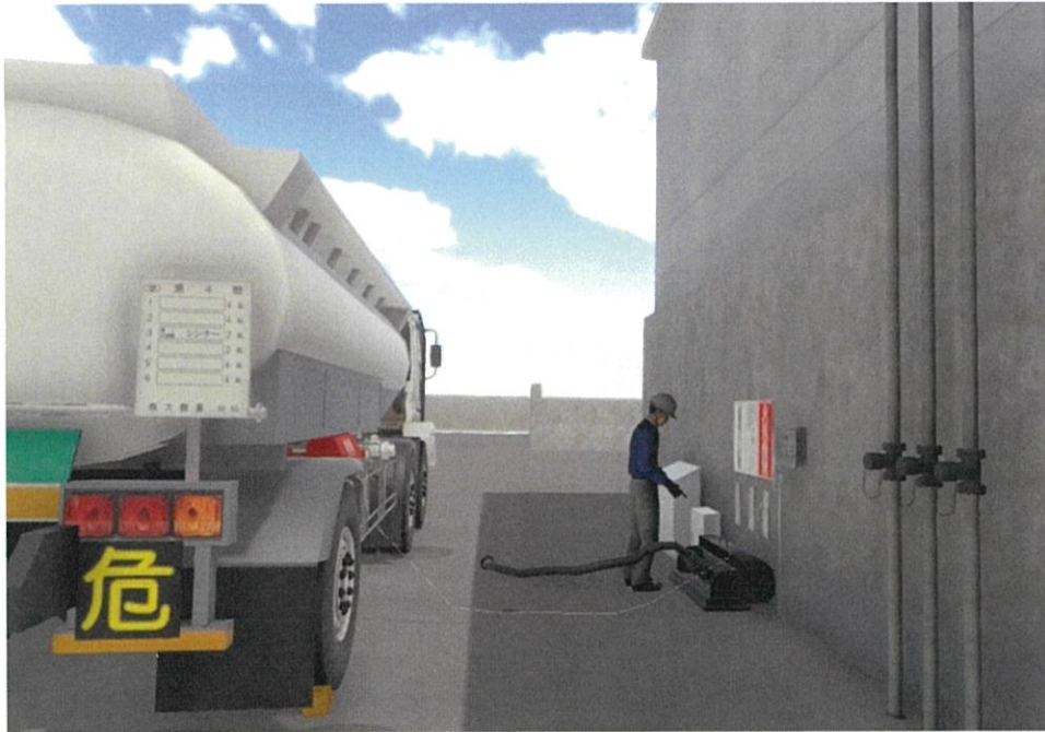
図 2 0 ローリーアース及び注入ホースの設定状況
