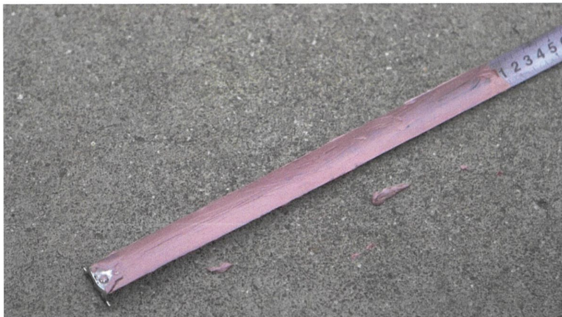
水ペーストを塗布し、タンク室内の水の有無を確認する。
