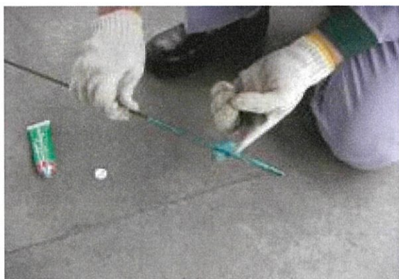
①検水棒に水ペーストを塗布する
