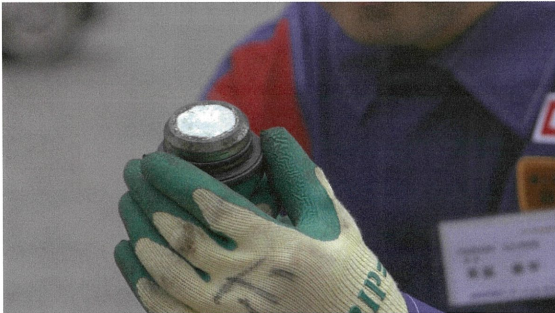
漏洩検査管の蓋の機能を確認。
