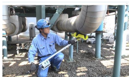
中性子水分計による測定状況
