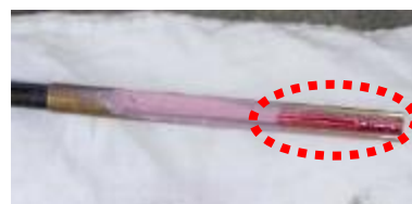
油ペーストを検尺棒等の先端に塗布すると油があれば、変色する。 （メーカーによって色は異なる）
