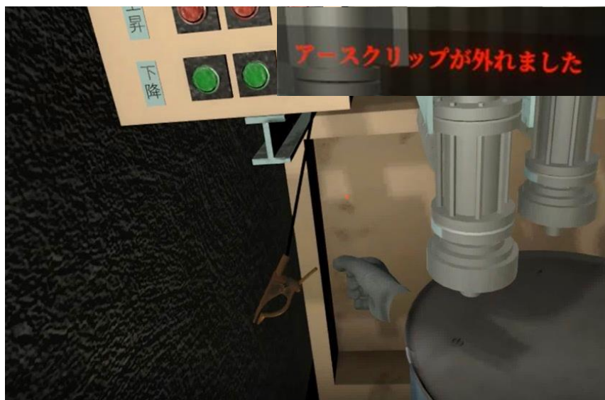
図－35 アースクリップの離脱状況
