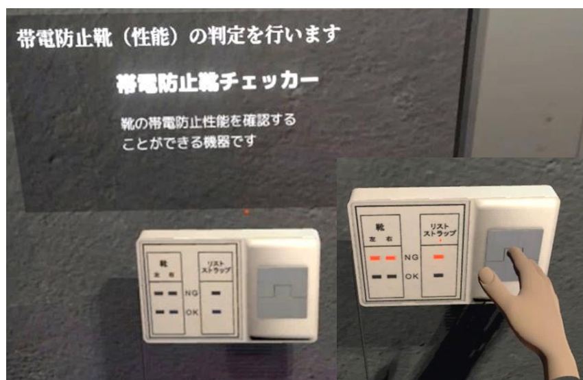
図－２６ 帯電防止靴の機能確認及び判定結果
