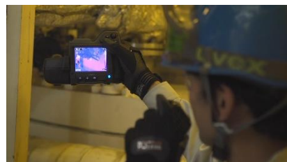
赤外線カメラの使用状況
