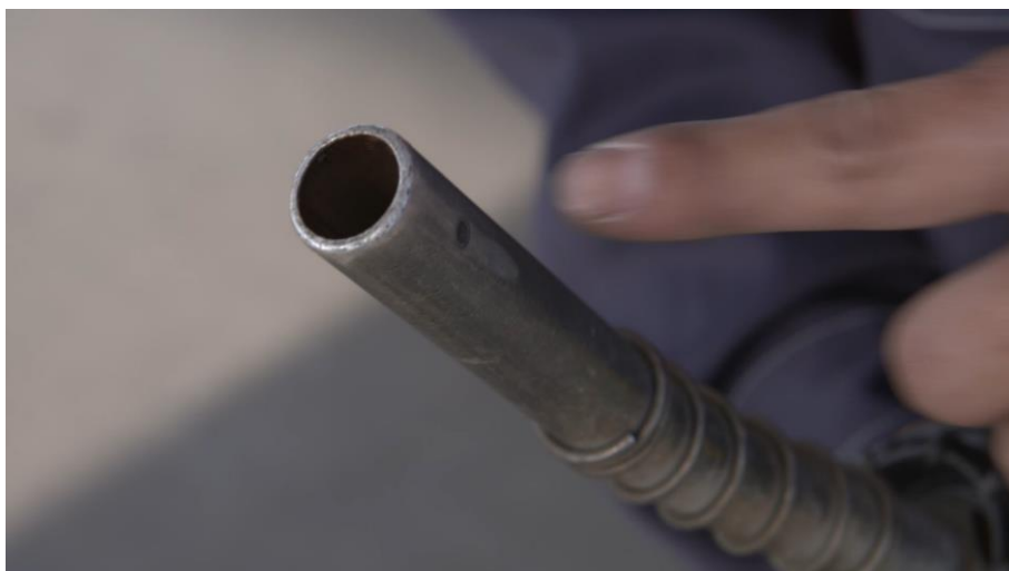
ノズルの確認。先端が摩耗していないか、センサー孔が潰れていないか、亀裂、損傷、結合部のゆるみがないか確認。
