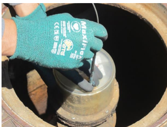
③検水口へ検水棒を挿入する
