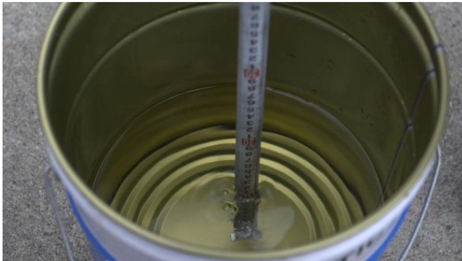
油の付着の確認。油の付着があれば油膜が生じる。
