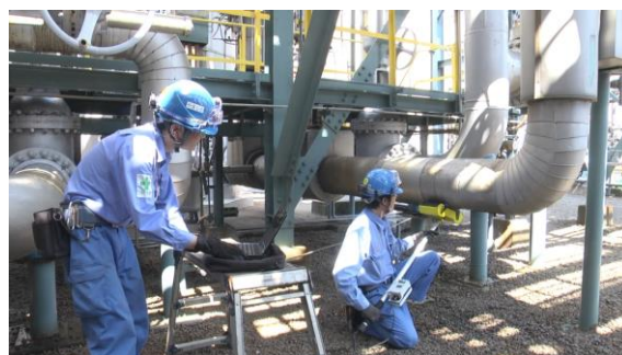
写真4 中性子水分計による測定の様子
