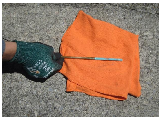
②検水棒先端部に塗布した状況
