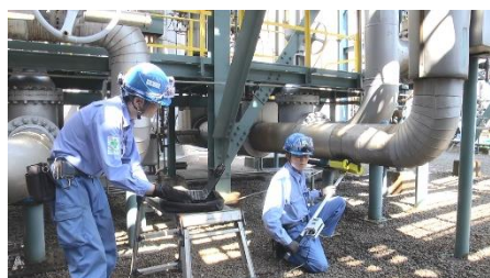
中性子水分計による測定状況
