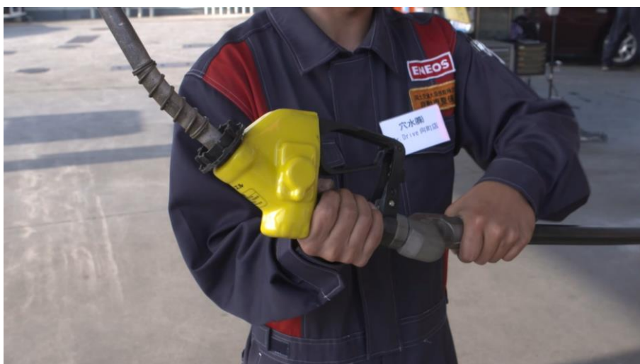
スィベルジョイントの確認。ホース接続部やノズル回転部に変形、破損、ゆるみ、隙間、がたつきがないか確認。
