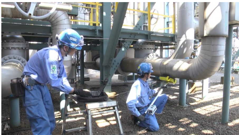
中性子水分計による測定。高速中性子が水素原子と衝突して熱中性子になる現象を利用して、保温材の水分量を測定し、腐食潜在箇所を予測できる。
