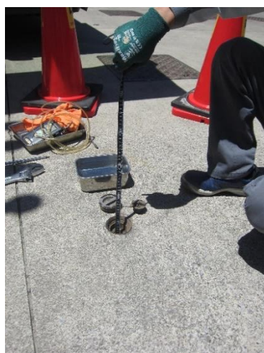
メジャーを挿入し点検する状況（メジャーの場合深さも測定できる）
