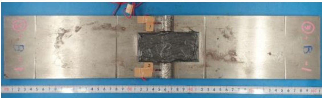
(b)疲労試験後
