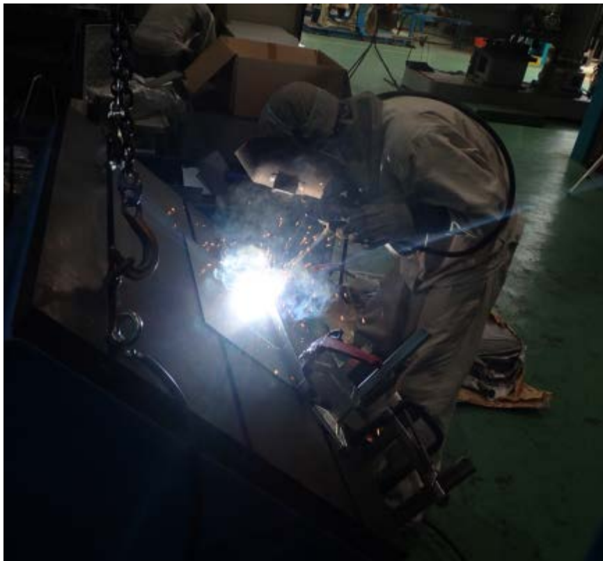
図 2-4 被覆アーク溶接作業
