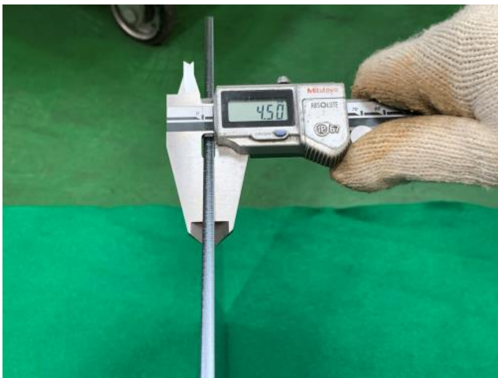
(b)板厚測定状況
