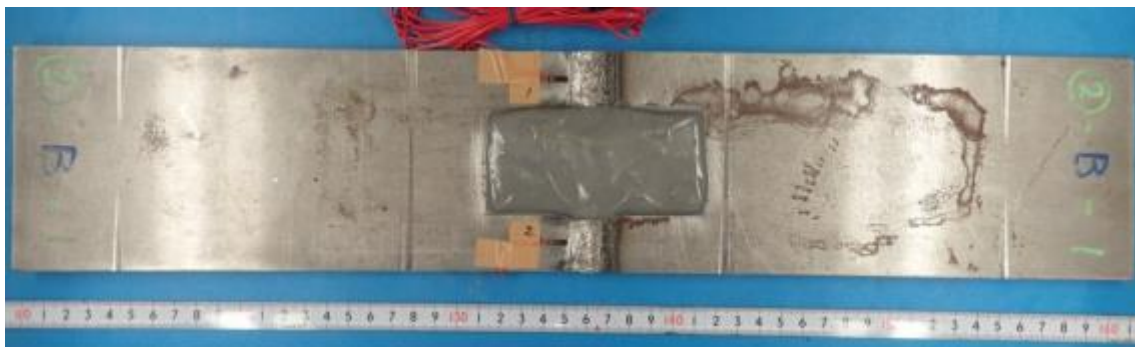
(b)疲労試験後
