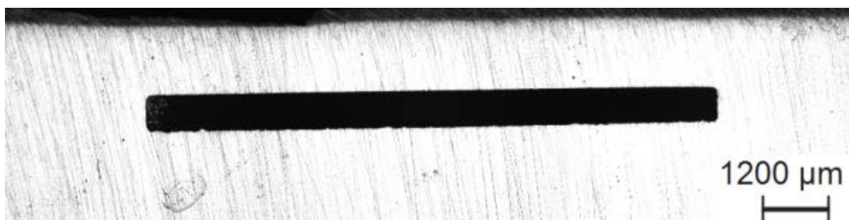
図 14-2 人工欠陥部のマクロ写真(措置②、ベロメタル、②-B-1)
