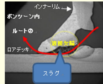
(2-4)溶接欠陥に起因する割れ
