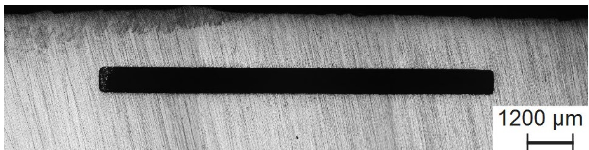
図 14-3 人工欠陥部のマクロ写真(措置③、デブコン、③-B-1)
