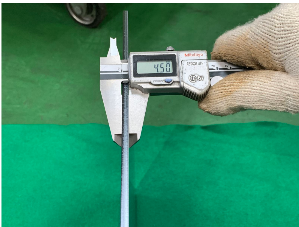
(b)板厚測定状況
