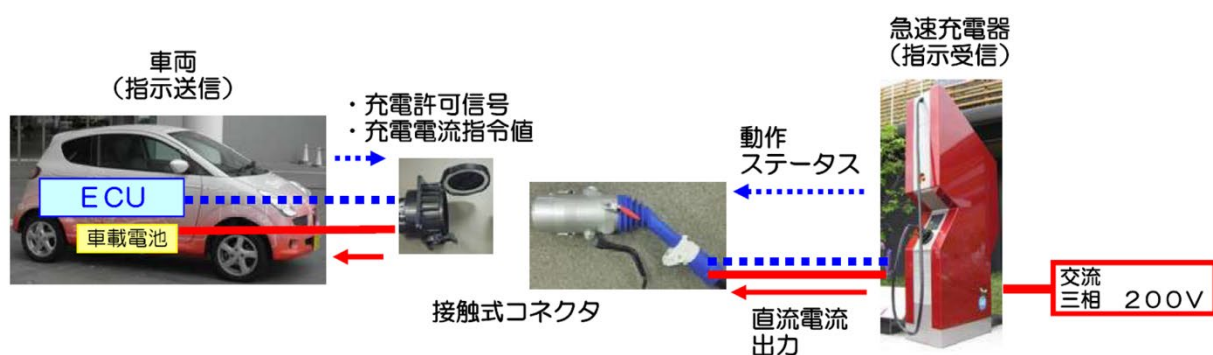
図2 急速充電設備（CHAdeMO プロトコル）の特徴
