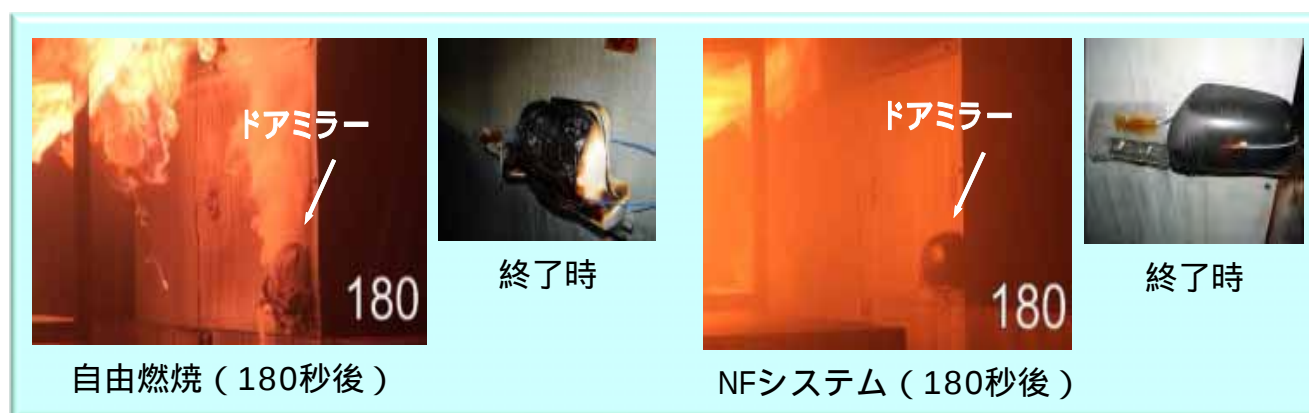
隣接車両への延焼防止確認状況
