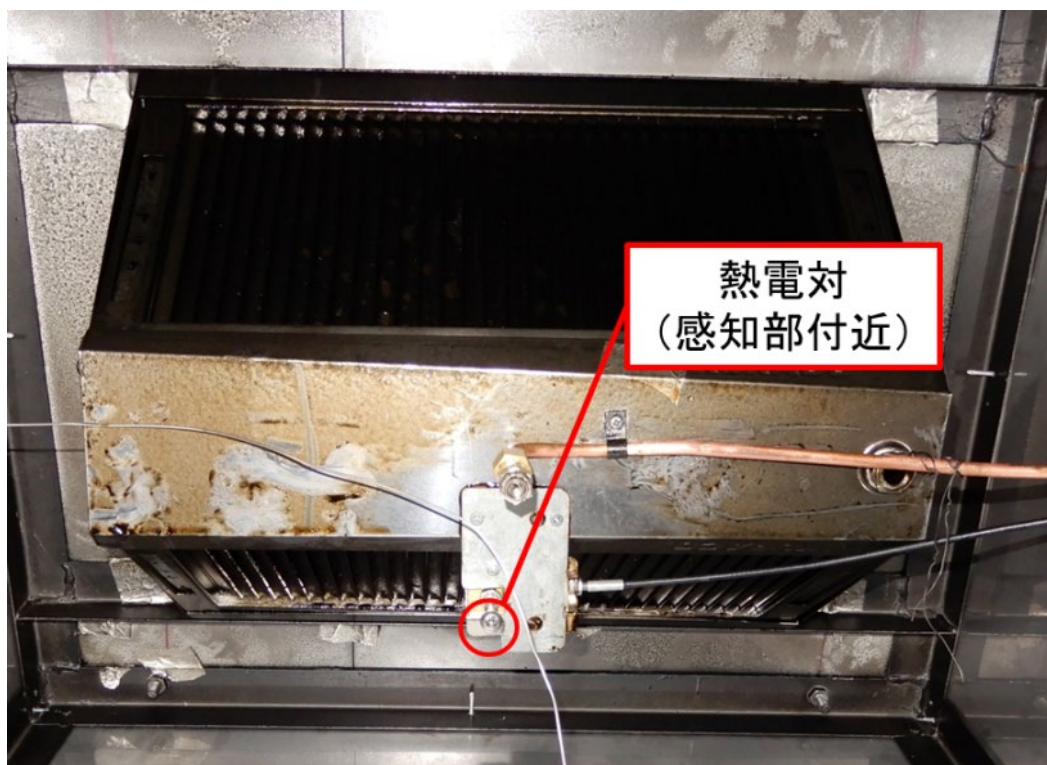
写真 3 フード部分（フライヤー火災用）の熱電対設置位置
