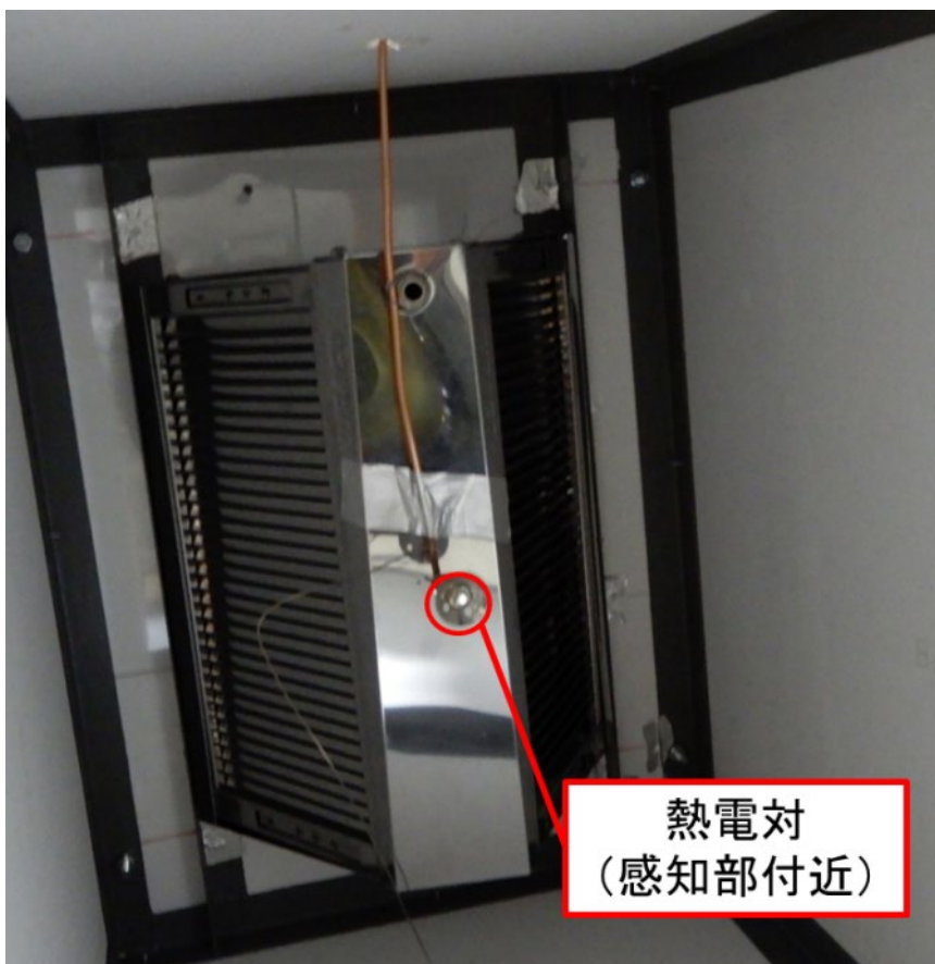
写真 1 フード部分（レンジ火災用）の熱電対設置位置
