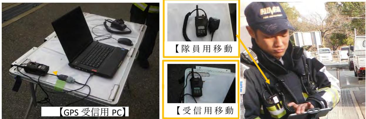
隊員が所持する移動局を開局すると同時に GPS 情報が発信され、受信用移動局にてその GPS 情報を取得し、PC の地図上に表示することができる。PC での表示は、位置だけでなく、隊名も表示される。また、移動局にはエマージェンシー通知機能も備えており、緊急情報も表示可能。
