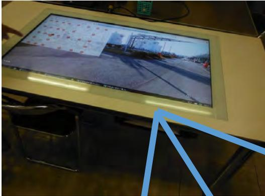
正門脇の警防室に設置されているテーブル型の大型モニター。タッチパネル操作が可能で、必要な情報をモニター上から選択して表示することができる。
