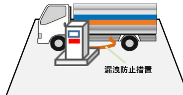
ホースの漏洩防止措置
