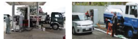
移動タンク貯蔵所と可搬式給油設備を接続した例
