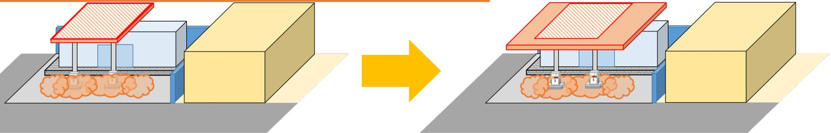
流出時における可燃性蒸気濃度の分布状況について、基準モデルと比較検証し安全性を評価する。
