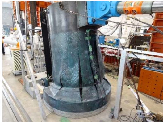
写真-5.3 実験模型の終局状態（円形）
