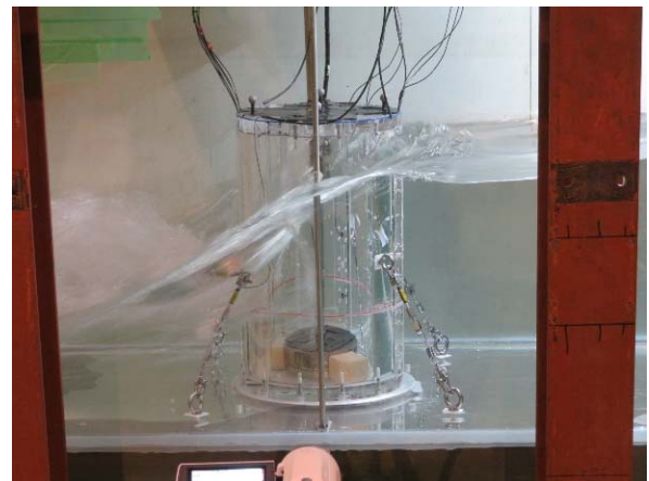
写真-4.1 ケース3における実験状況 (対策工2, 設置角 60^\circ )
