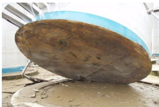
図 2-13 No.8 タンクの傾斜状況②
