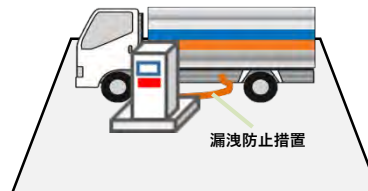
ホースの漏洩防止措置
