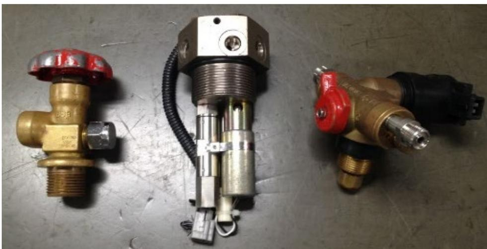
左：手動タイプ      中央：電磁弁タイプ      右：電磁弁外付きタイプ
