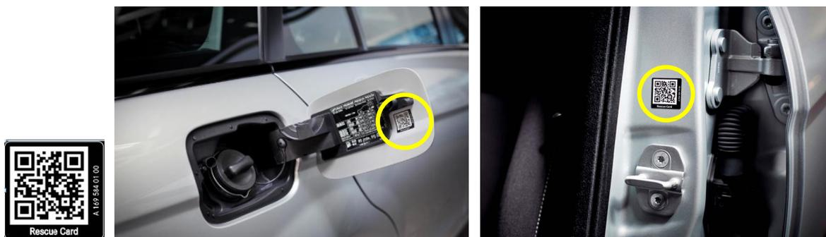
この「QRコード」は、給油口フラップ裏側と給油口の反対側のドアを開けたボディ側の2箇所（同時に激しく損傷を受ける可能性が低い2箇所）に貼付されている。
