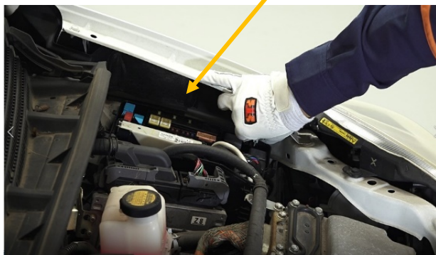
※ヒューズの抜き差し用工具が備えられている場合がある。
