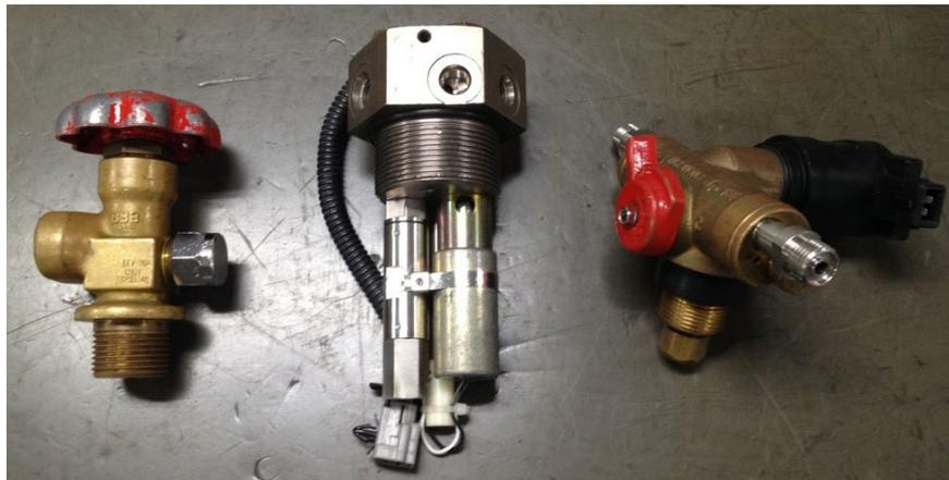
左：手動タイプ    中央：電磁弁タイプ    右：電磁弁外付きタイプ
