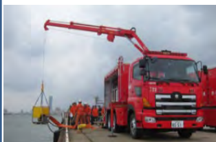
大容量送水ポンプ車 (無償使用車両)
