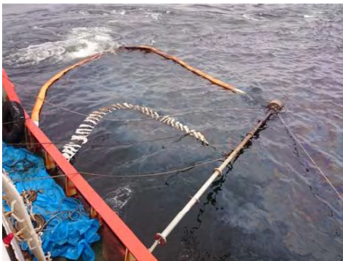
写真8-8-7 万国旗状吸着材とオイルフェンス 直線展張曳航による極薄油膜の回収
