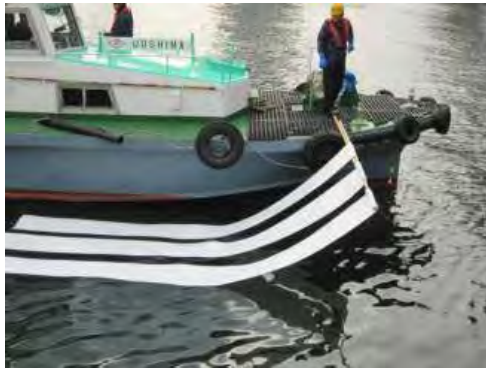
写真8-8-5 ロール状吸着材曳航による 極薄油膜の回収
