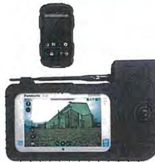
超耐久タブレット (FZ-M1) をベースに、3軸ジョイスティック、長距離無線装置、人間工学に基づいた操作部を搭載。カメラ映像のリアルタイム表示可能
