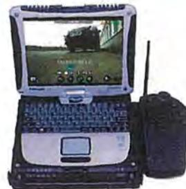
超耐久タブレット (CF-19/CF-20) をベースに、3軸ジョイスティック+ボタン、長距離無線装置、人間工学に基づいた操作部を搭載。カメラ映像と地区操作のリアルタイム表示可能
