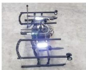
UT Roof drone
