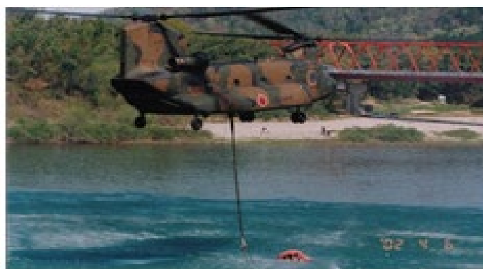
CH-47取水状況
