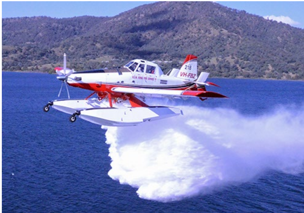
Air Tractor AT-802F(米) 搭載水量 最大約3t
