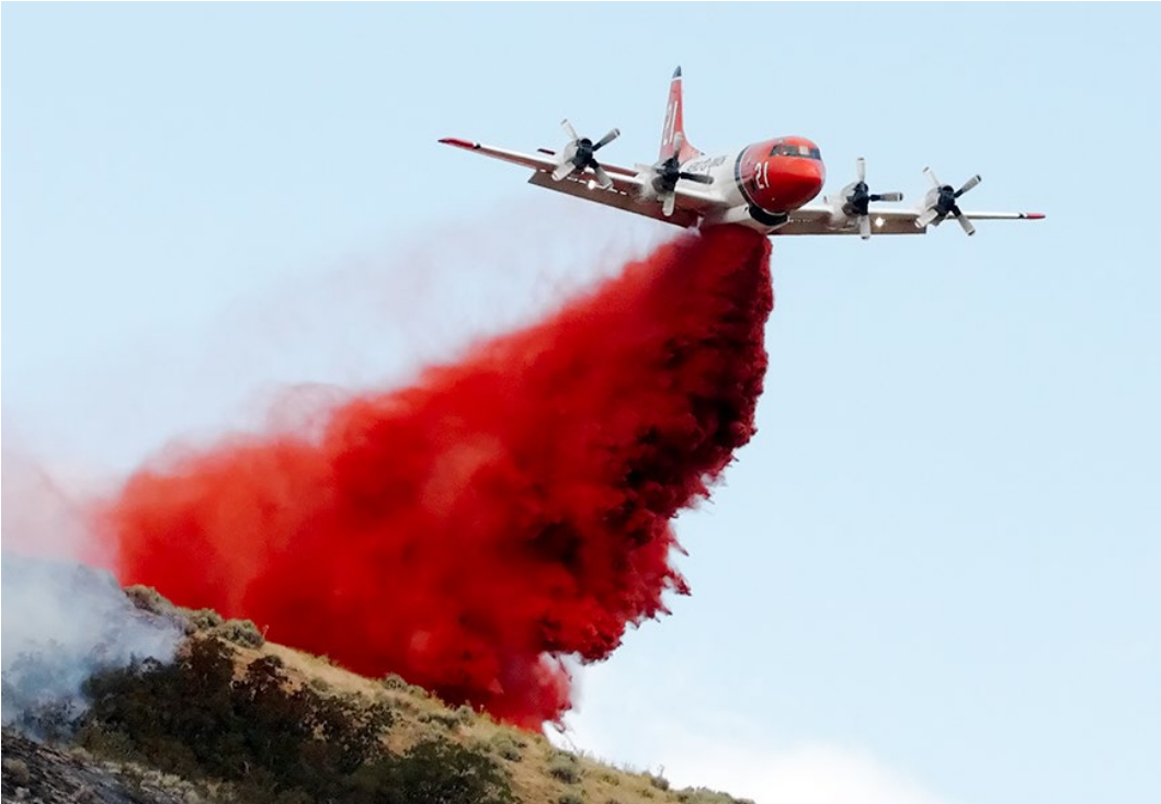
P-3A(米) 搭載水量 最大約11t
