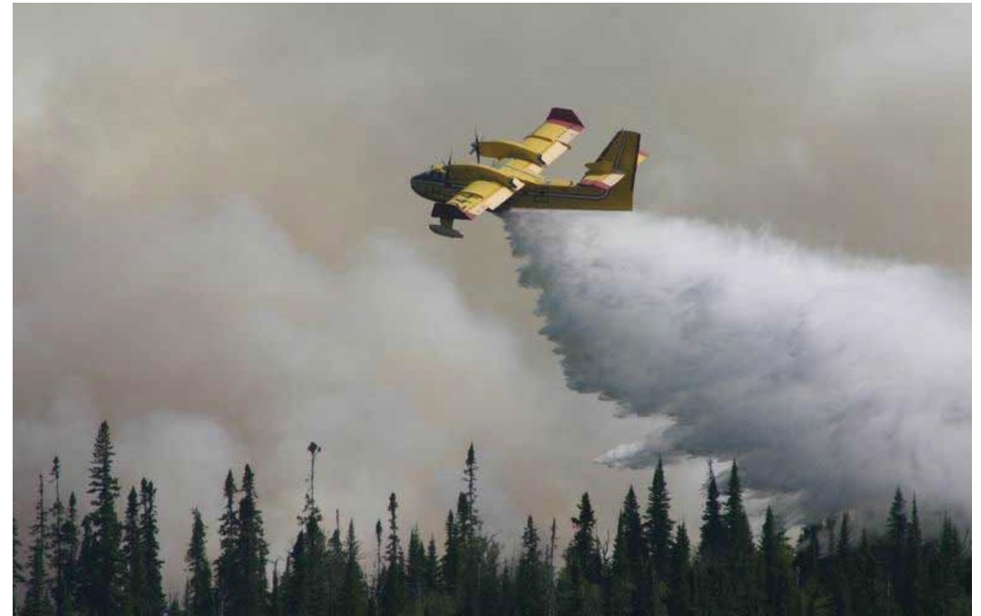
CL-415(カナダ)・・・現在CL-515の開発を計画中 搭載水量 最大約6t
