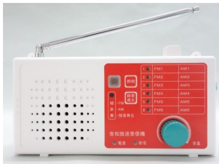
FM放送を活用した同報系システムの屋内受信機（自動起動ラジオ）の場合
