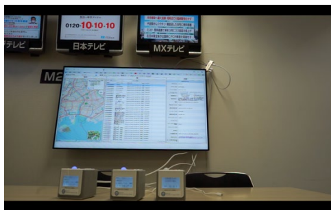
図 4 3 台の戸別受信機とアンサーバック確認画面。背景には MX テレビの放送が映っている。
