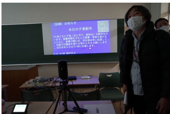
写真 22 サイネージはモニターに比べ消費電力を押さえられるプロジェクター型の Android TV で実装。
