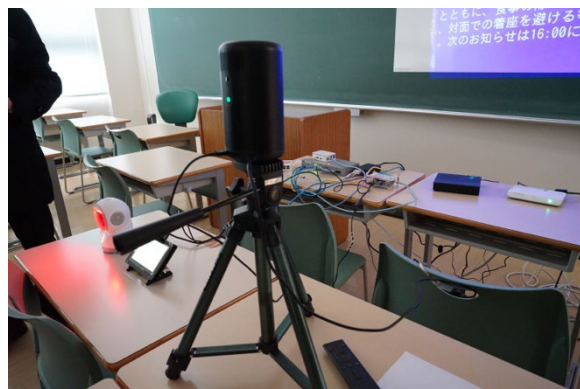
写真 23 プロジェクター型 AndroidTV に三脚をつけて自立。たためばコンパクトに収納が可能
