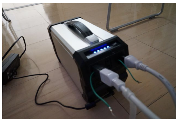
写真 21 避難所内の全装置をバッテリーで駆動した
