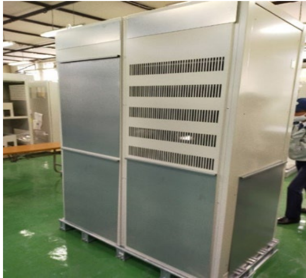
図 4 - 7 換気口に鋼板を貼り付け一時貯蔵
