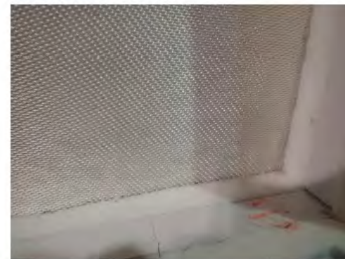
写真 8 試験後の耐火クロスの状況 (試験体記号 2, 加熱側近影)
