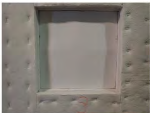
写真9 試験後の耐火クロスの状況 (試験体記号3,加熱側)
