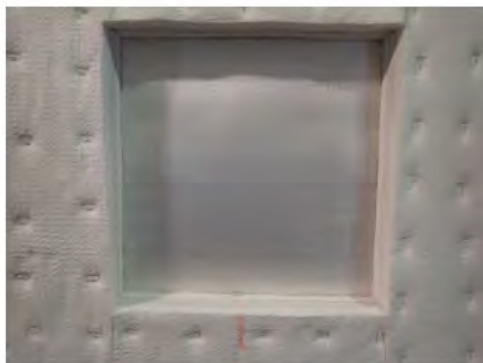
写真 5 試験後の耐火クロスの状況 (試験体記号 1, 加熱側)
