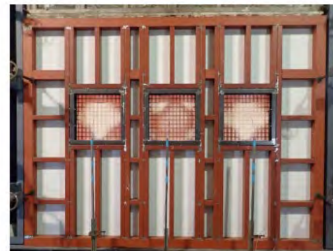
写真3 試験終了時の非加熱側の状況（換気口設置側）
