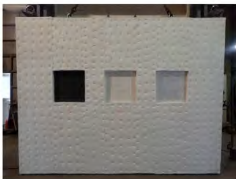
写真2 試験前の加熱側の状況（耐火クロス設置側）
