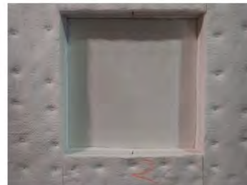
写真 7 試験後の耐火クロスの状況 (試験体記号 2, 加熱側)
