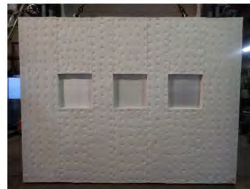
写真4 試験後の加熱側の状況（耐火クロス設置側）
