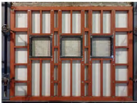
写真1 試験前の非加熱側の状況（換気口設置側）
