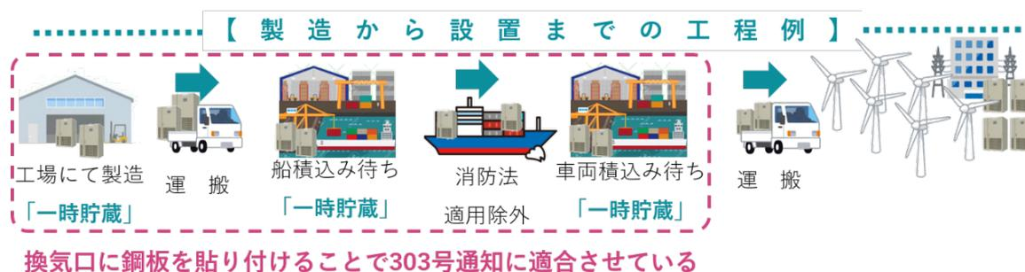
図3-6 キュービクル式リチウムイオン蓄電池の工程 (イメージ)
