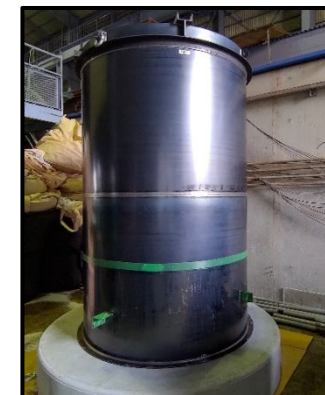
ケレン後のタンク
