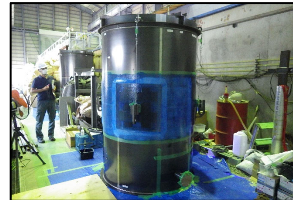
エポキシ樹脂下塗り
