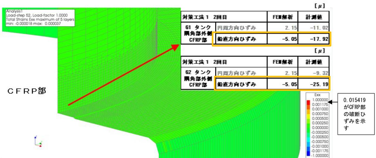
図3-82 CFRPの側板鉛直・RCスラブ半径方向ひずみ  $\epsilon_x$
