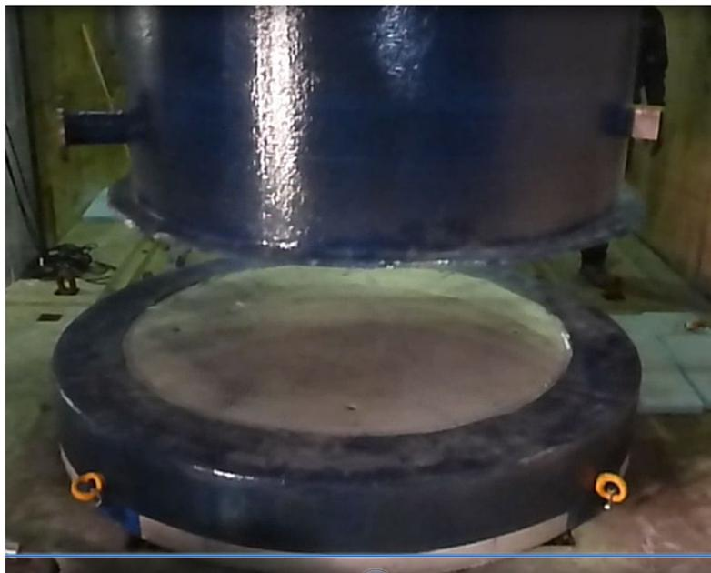
図3-57 対策工法1の実験後のCFRP内の状況（浸水のないことを確認）
