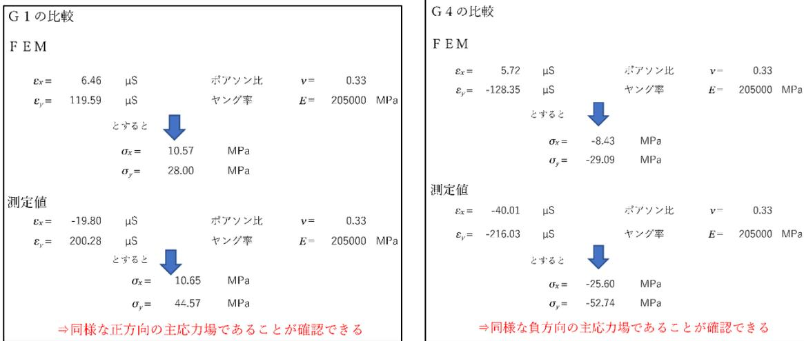
図3-100 タンク隅角部G1, G4のひずみから主応力への変換 (実験1回目)
