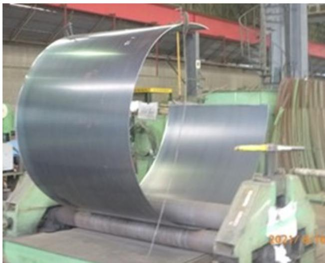
図3-36 タンク側板の板曲げ
