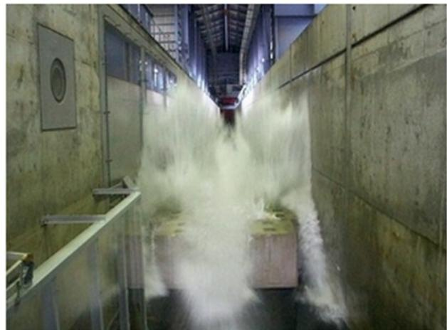
図3-32 大規模波動地盤総合水路（国立研究開発法人 港湾空港技術研究所 ホームページより引用）
