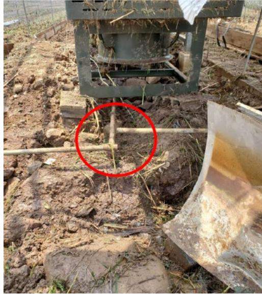
図 2-9 破損した配管
